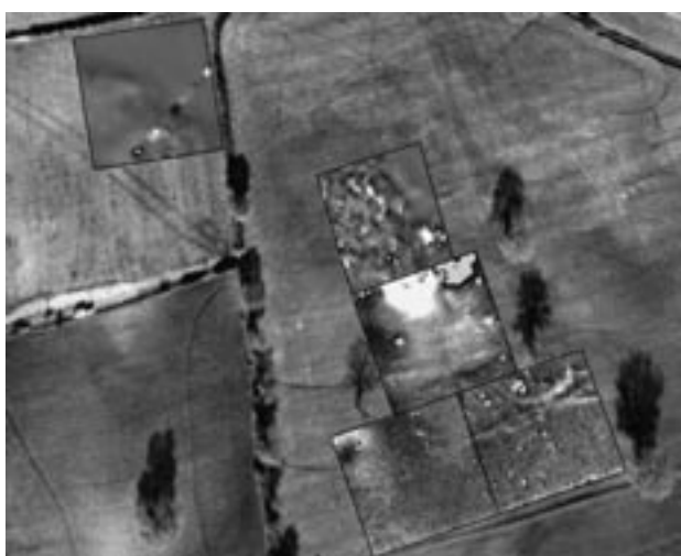
Fig. 2 – Restituzione grafica delle misure magnetiche in località Serratone.
