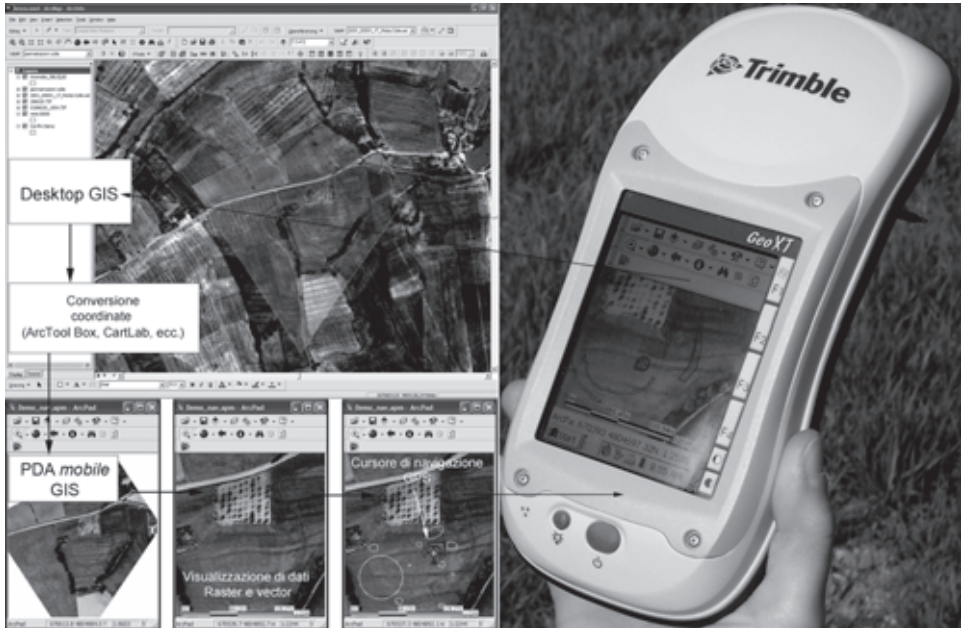
Fig. 5 – Visualizzazione dei dati disponibili sul PDA per la navigazione in corrispondenza di anomalie telerilevate.
