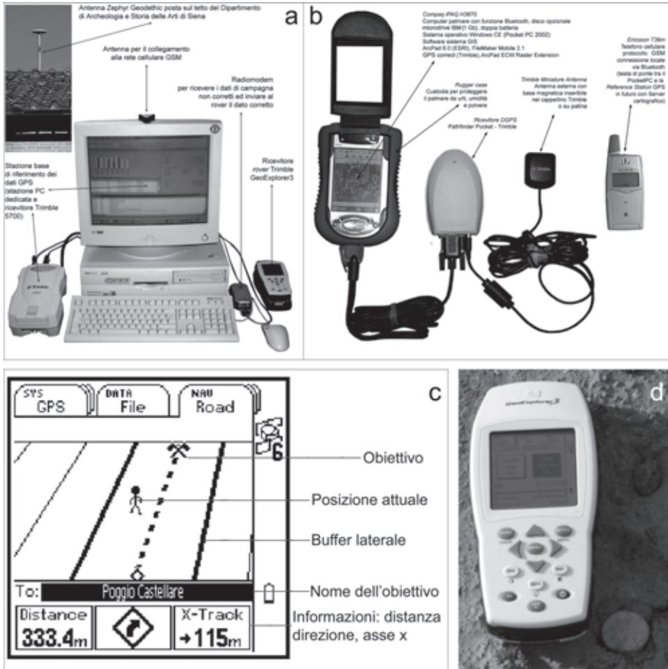
Fig. 1 – a: Stazione base GPS installata presso il Dipartimento di Archeologia e Storia delle Arti di Siena; b: Sistema iPAQ PDA/GPS; c) interfaccia di navigazione di un rover tradizionale; d) rilievo di un reperto particolare nel corso delle ricognizioni di superficie.
