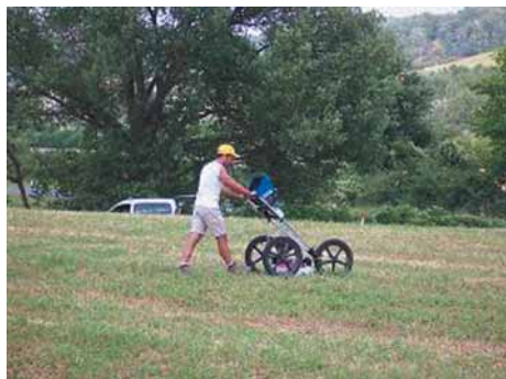
Fig. 5 - Sistema Georadar SIR-3000 della GSSI.
