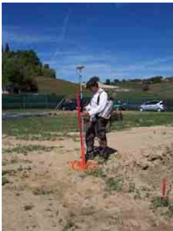
Foto 7: acquisizione delle coordinate dei punti di controllo con GPS centimetrico (Pava Luglio-Agosto 2004)
